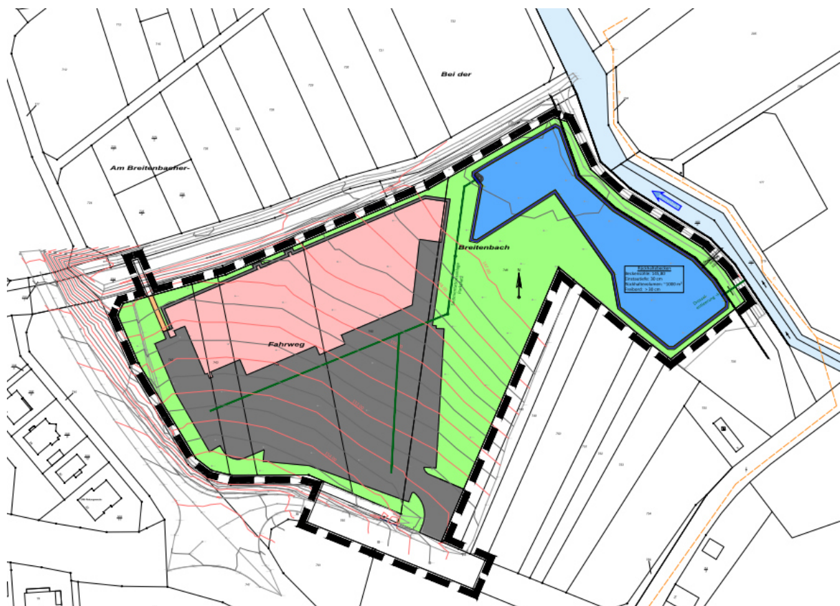
Abb. 2: Übersichtslageplan Entwässerungskonzept Niederschlagswasser
